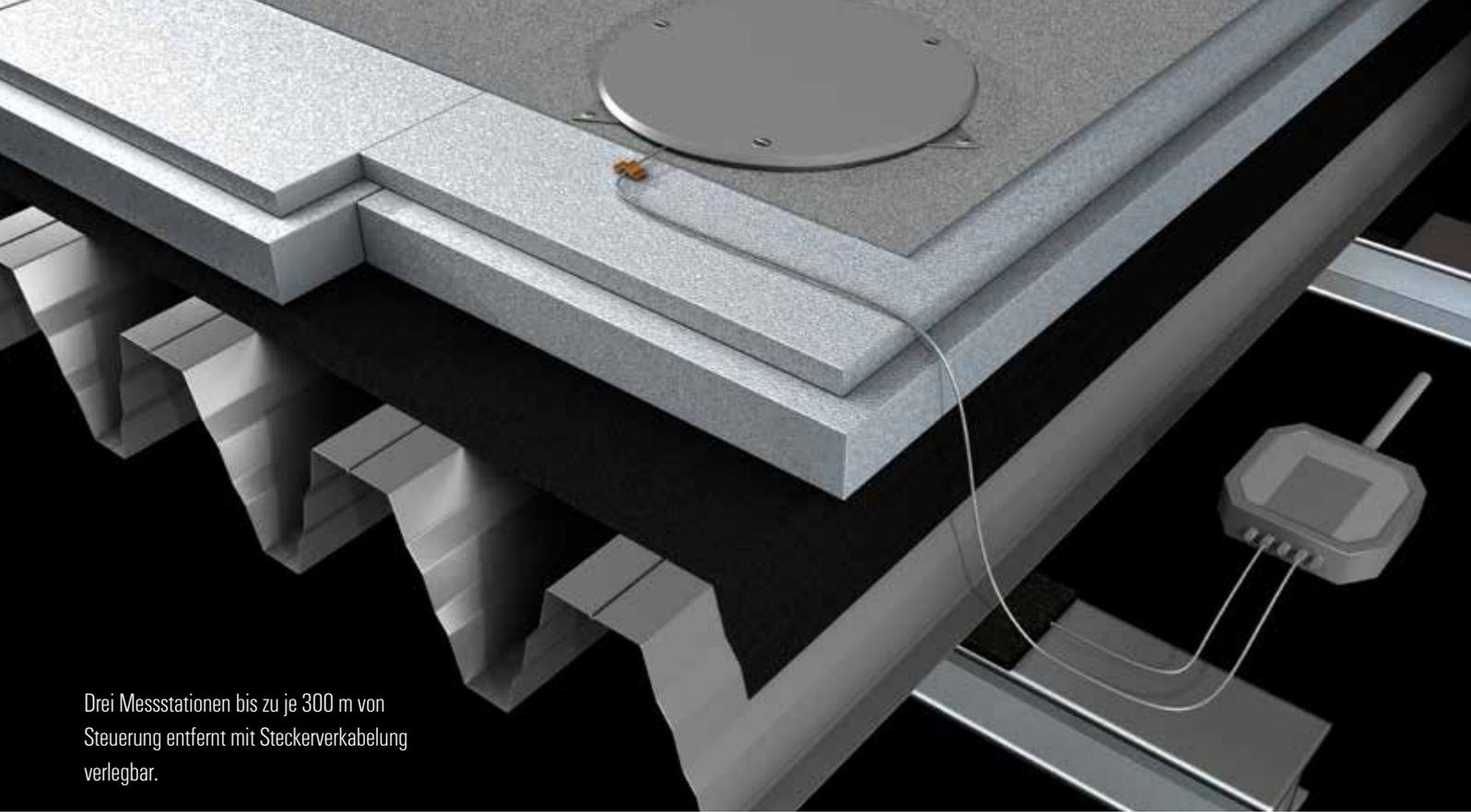
Drei Messstationen bis zu je 300 m von Steuerung entfernt mit Steckverkabelung verlegbar.
