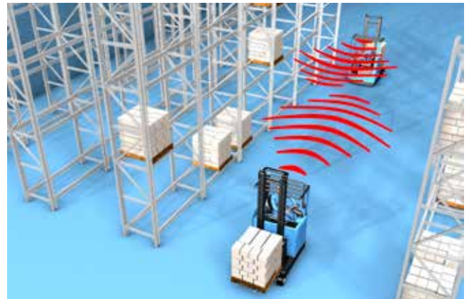
Automatische Geschwindigkeitsreduzierung bei Begegnung im Breitgang Ermöglicht 25% mehr Lagerkapazität
