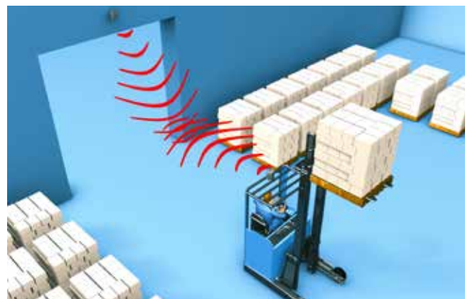
Hubhöhenkontrolle an Toren und Durchfahrten Reduzierte Instandhaltungskosten
